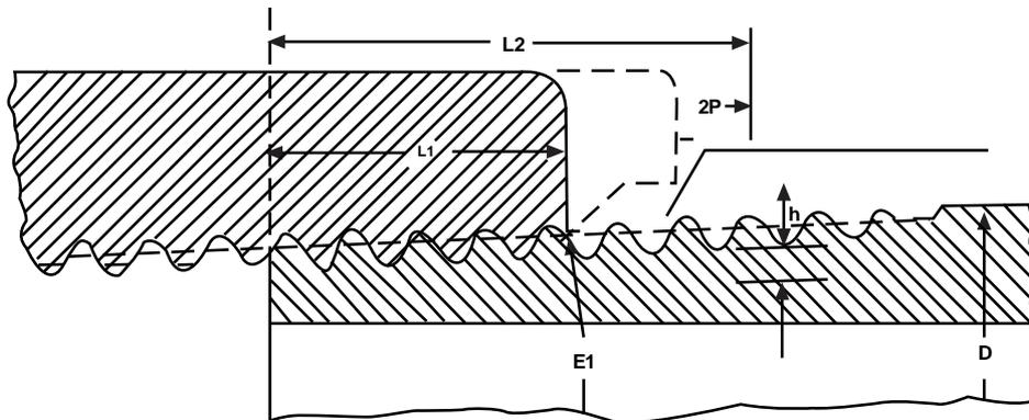
El cono de la rosca es 0.75 pulgada/pie medida en el diámetro y a lo largo del eje. La cresta y el valle de la rosca de la conexión es cortada a un mínimo de 0.033 pulgadas.
